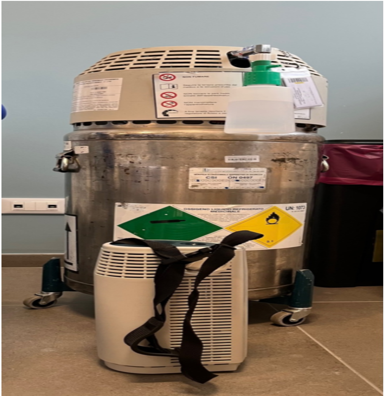
Figura 5. Contenitore criogenico (“bambola”) di ossigeno liquido. In primo piano uno stroller .
