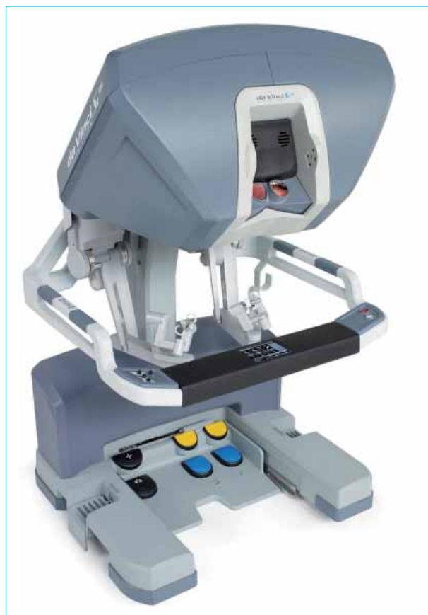
Fig. 2 - Consolle chirurgica. Da questa postazione il chirurgo opera manovrando gli strumenti della torre.
