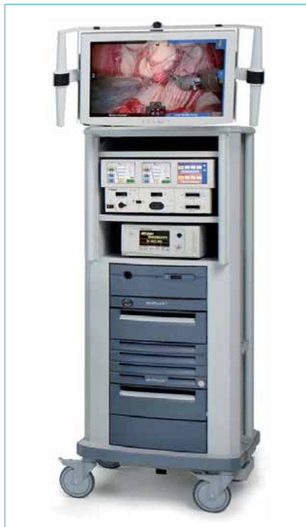
Fig. 4 - Carrello. Il carrello, in modo analogo a quanto accade in laparoscopia tradizionale, contiene la tecnologia ausiliaria necessaria al funzionamento del sistema ed all'esecuzione dell'intervento chirurgico.
