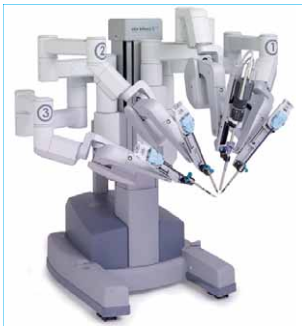
Fig. 3 - Torre. La torre sorregge e manovra, seguendo i comandi ricevuti dalla consolle, l'ottica e gli strumenti chirurgici.
