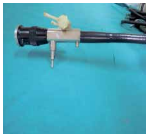
Figura 3 - Particolare dell'estremità prossimale del fibroscopio. In senso orario, partendo da sx: oculare, leve per chiudere il canale per l'irrigazione e l'insufflazione dell'aria, canale per l'irrigazione e l'insufflazione dell'aria, raccordo per la fonte luminosa.
