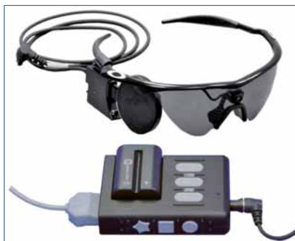
Figura 4 - La telecamera posta sugli occhiali e il computer per l'elaborazione delle immagini.
