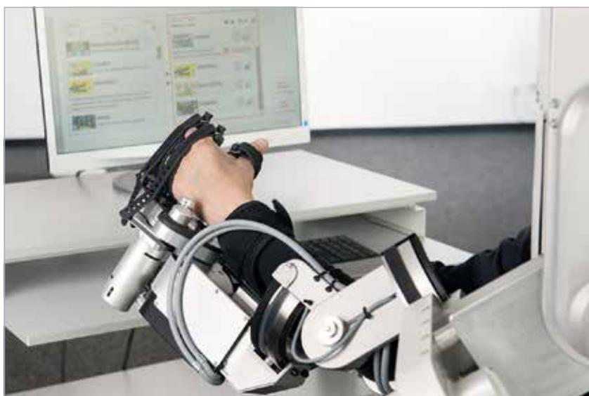
Figura 4 - Sistema robotico Armeo Power - Hocoma
