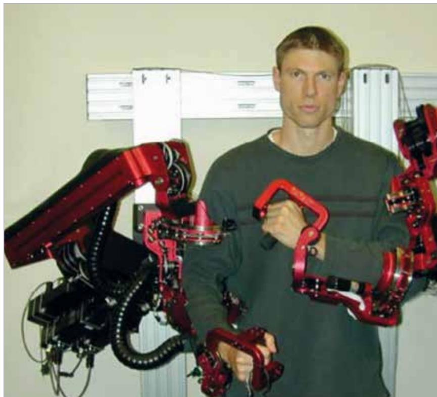
**Figura 5** - Sistema robotico a 7 gradi di libertà per l'arto superiore
