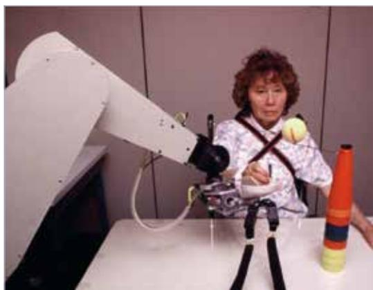
Figura 1 - Sistema robotico MIME
